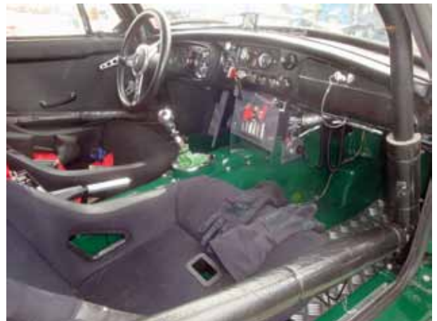
Cockpit med två tävlingsstolar och en stabil skyddsbur. Instrumentbräda och dörrarnas sidopaneler är intakta men resten av inredningen är borttagen.
