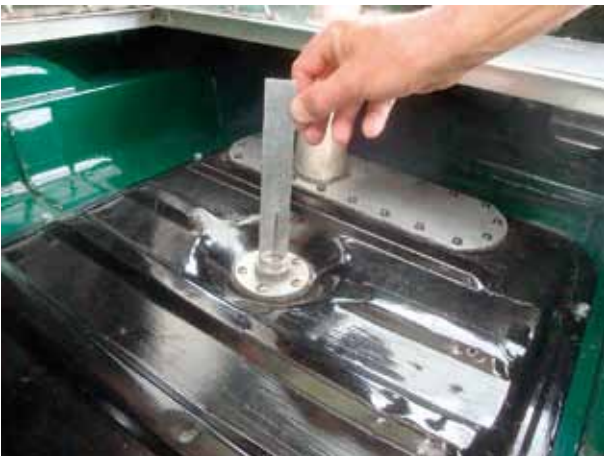
Kontroll av bränslenivå, locket skruvas av, flottören med pigg flyter upp och uppstickshöjden kan mätas med en specialsticka.
