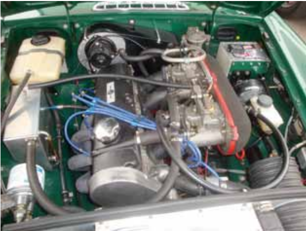
Motorrummet i en annan vy. Vänster sida fritt sittande oljefilter, oljeuppsamlingsbox för vevhusventilationen. Notera att värmesystemet är bibehållet.
