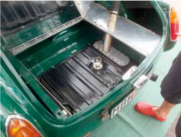
"Bagagen" med en nedsänkt Volvo Amazon bensintank. Original Volvo tankgivare är ersatt med flottör, som döljs av skruvlocket.
